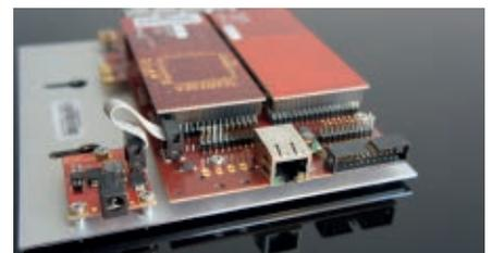
beroNet VoIP Gateways lassen sich mit bis zu 2 Modulen bestücken und sind daher sehr flexibel, sodass sie an unterschiedlichste Kundenanforderungen angepasst werden können.
